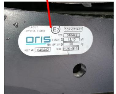
Si le dispositif d'attelage est composé de plusieurs pièces vissées entre elles (p. ex. traverse et boule d'attelage), celles-ci doivent comporter chacune une plaquette du constructeur. Elles doivent être inscrites séparément sur le formulaire, comme indiqué ci-dessus.
