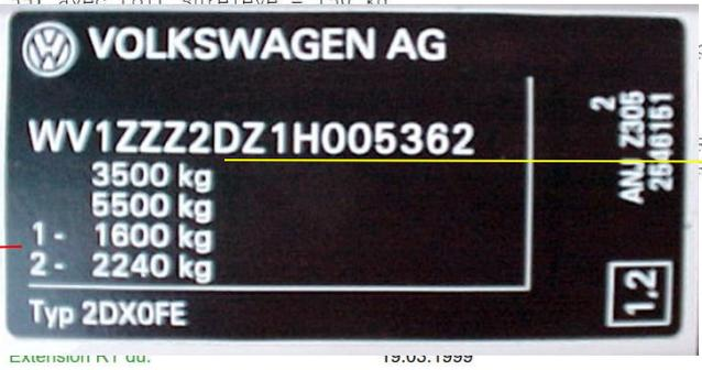
Les données de la plaquette du constructeur doivent correspondre à celles de la FD / RT. À défaut, il faut clarifier avec l'importateur si c'est la FD / RT ou la plaquette du constructeur qui est fautive.
