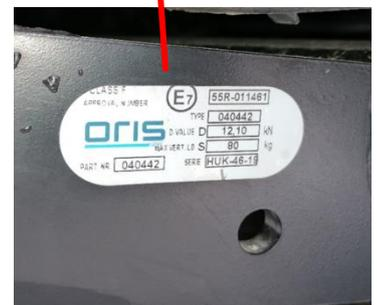
Besteht eine Verbindungseinrichtung aus mehreren verschraubten Teilen, zum Beispiel Traverse und Kugelkupplung, müssen diese einzeln gekennzeichnet sein. Die einzelnen Bauteile müssen wie oben beschrieben im Formular Anbaubestätigung Anhängerkupplung (Anhängevorrichtung) eingetragen werden.
