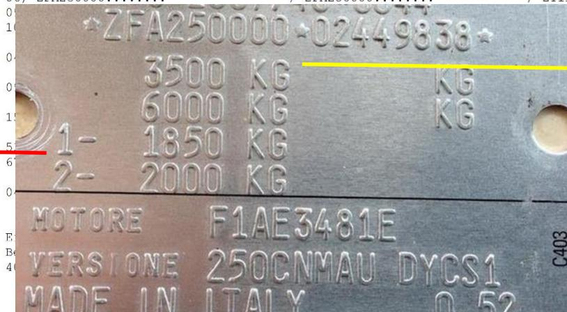
Angaben auf dem Herstellerschild müssen im Bereich der Angaben auf dem Datenblatt / der Typengenehmigung liegen. Sollte dies nicht der Fall sein, muss über den Importeur abgeklärt werden ob eine falsches DB / falsche TG vorliegt oder ein falsches Herstellerschild vorhanden ist.
